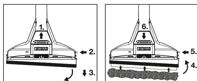
Szerelje le a felcsapható keménypadló-adaptert a szőnyegpermetező fejről úgy, hogy a tolókát felfelé tolja, majd a fej piros záróreteszét kifelé nyomja. Lazítsa ki a keménypadló-adaptert a zsanérból és vegye le!
