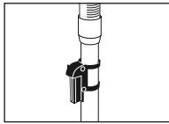
Изменяется по высоте телескопическая всасывающая труба с фиксатором для стоячного положения
