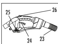
Всасывающий шланг (23) с интегрированным распылительным шлангом, изогнутая труба с запорным клапаном (24), регулятор количества воды (25) и механический регулятор силы всасывания (26)
