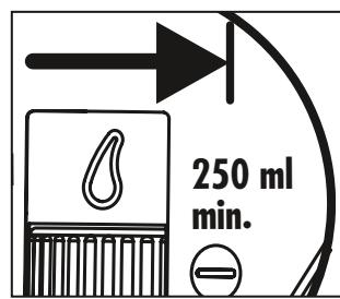
Ustaw regulator strumienia wody (25) na minimum. Rozpocznij spryskiwanie (2-3 sekundy) w celu zmoczenia ściereczki z mikrofibry (białej). Należy unikać zbyt silnego zmoczenia parkietu lub podłogi, szczególnie na jej skrajach z tego względu, że skrajne części podłogi są zwykle gorzej zabezpieczone przed wilgocią.
