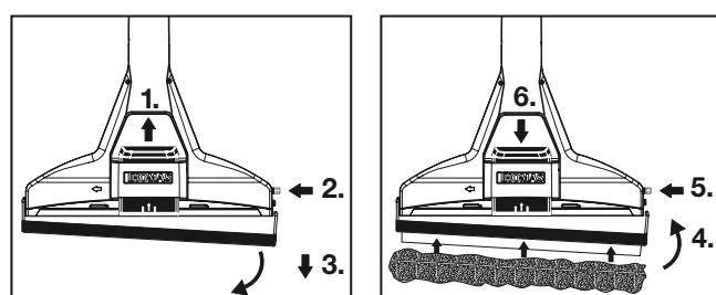
W celu demontażu adaptera do podłóg twardych od dyszy natryskowej czyszczącej dywanu przesuń suwaka do góry i przestaw do wewnętrzny czerwony zamek dyszy natryskowej. Zdejmij adapter do podłóg twardych z zawiasów.
