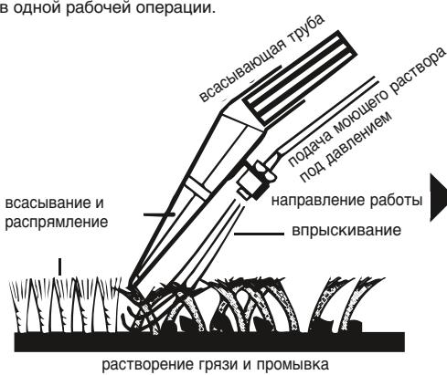
Нажать рычаг запорного клапана (24) до выхода моющей жидкости, а приложенную к ковру насадку провести прямой полосой по ковру. Количество распыляемой жидкости можно плавно регулировать колесиком, размещенным на рукоятке. В конце полосы или при перерыве отпустить рычаг клапана, чтобы остановить струйное распыление. После того как распыленная жидкость собрана, приподнять насадку и начать новую полосу с небольшим наложением на предыдущую. Так полосу за полосой можно обработать всю поверхность.
