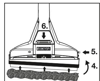
Demontieren Sie den klappbaren Hartbodenadapter von der Teppich-Sprühdüse, indem Sie den Schieber nach oben ziehen und dann den roten Sperrriegel der Düse nach innen drücken. Den Hartbodenadapter aus seiner Scharnier lösen und abnehmen.
