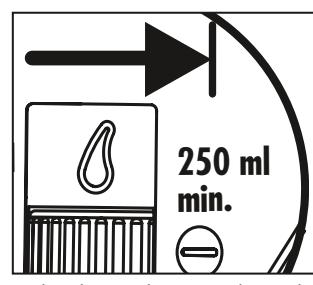
A vízmennyiségszabályozót (25) állítsa „min”-re! Hozza működésbe 2-3 másodpercre a permetezési műveletet, és nedvesítse meg a mikroszálas lapot (fehér)!
