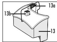
Резервуар для грязной воды (13), включая «мокрый» фильтр (13a) и поплавок (13b)\*
