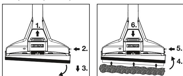
Silme adaptörünün montajı işlemi tersine takip ederek gerçekleştir.
