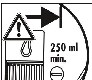
Wassermengenregler (25) auf „min“ stellen. Sprühvorgang für 2-3 Sekunden auslösen und Microfaserpad (weiß) anfeuchten. Eine Durchnässung der Oberfläche muss generell vermieden werden, da unter Umständen der Kantenbereich der Parkett- bzw. Dielenelemente keinen ausreichenden Feuchtigkeitsschutz besitzt.
