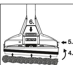
Demonteer de omklapbare adapter voor harde vloeren van de tapijtsproeier door de schuif naar boven te trekken en vervolgens de rode borggrendel van de zuigmond naar binnen te drukken. De adapter voor harde vloeren uit zijn scharnier losmaken en verwijderen.
