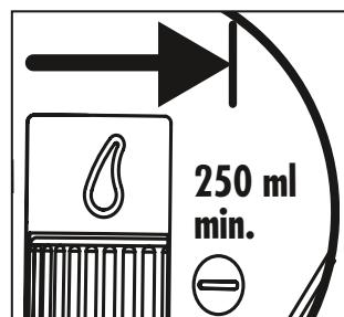
De watervolumeregelaar (25) op „min“ zetten. Spoeiprocedé 2-3 seconden activeren en de microfiberpad (wit) vochtig maken.
