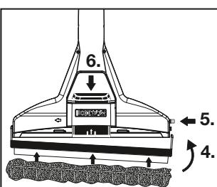
Démonter l'adaptateur rabattable pour sols durs du suceur injecteur pour tapis en tirant le coulisseau vers le haut puis en appuyant vers l'intérieur sur le verrou rouge du suceur. Dégager l'adaptateur de ses charnières et le retirer.
